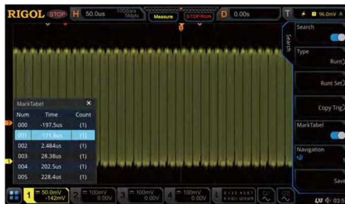
Функция поиска и навигации позволяет быстро находить сигналы с особенностями и точно определять их местоположение.
