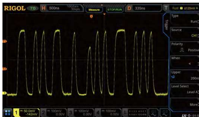
Запуск по импульсу нетипичной амплитуды поможет захватить нужный сигнал в последовательности импульсов.
