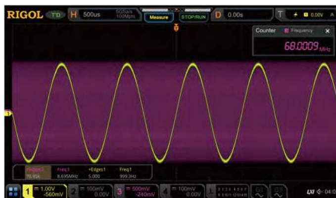
Обычное измерение с использованием 1 млн. отсчетов не позволяет точно измерить частоту высокочастотного сигнала.
