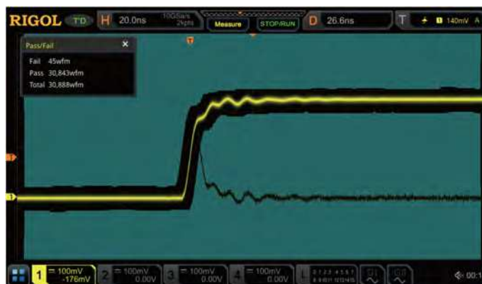
Функция допускового контроля позволит быстро получить для сигнала статистику о вероятности отклонений от нормы.
